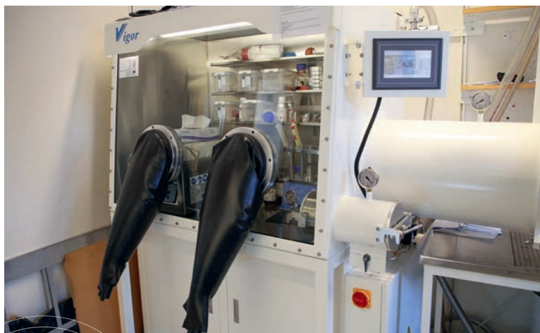
TILLVERKNING AV SMÅ PARTIKLAR: I den här apparaten kan mycket användbara nanopartiklar skapas av kisel.
