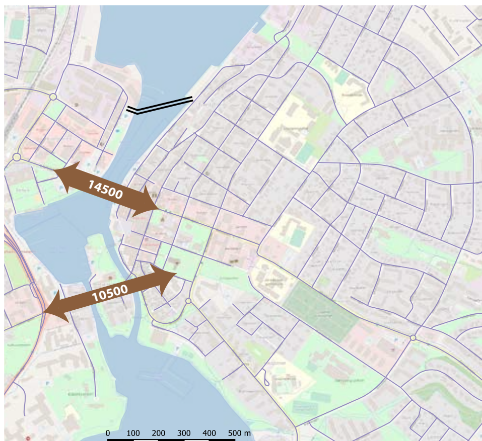
Figur 2. Trafikströmmar över broarna och ett läge om det blir en ytterligare bro.
